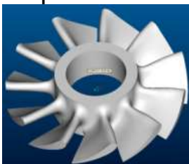
5. CAD модель по результатам оцифровки
