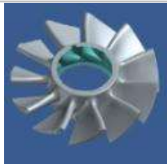
2. Модель после оцифровки
