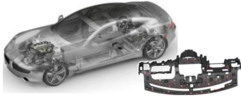
Приборная панель из композитов с длинными углеродными волокнами
