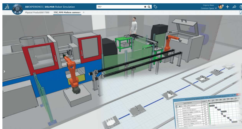
Рис. 4. Модель производственной ячейки и технологического процесса, представленная с помощью диаграммы Ганта (как показано в DELMIA 3DEXPERIENCE)
