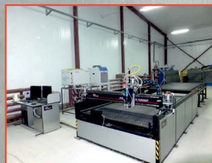
ЛАЗЕРНЫЕ СТАНКИ С ВОЛОКОННЫМИ ЛАЗЕРАМИ IPG МАЛОЙ МОЩНОСТИ ДЛЯ РАСКРОЯ ТОНКОЛИСТОВОЙ И ЭЛЕКТРОТЕХНИЧЕСКОЙ СТАЛИ
